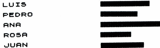
Fig. 2.10. Diseño de un gráfico de barras horizontales para el Spectrum. Los datos son los apropiados para no tener que utilizar una transformación a escala.
